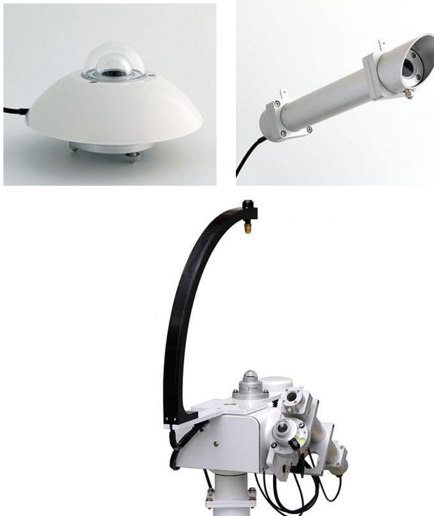
Fig. 3.9 – Piranômetro (esquerda) e pireliômetro (direita). Abaixo rastreador utilizando os dois equipamentos. A haste escura mantém o piranômetro sombreado de forma a medir somente a radiação difusa. A radiação total neste arranjo é obtida somando-se a medição dos dois equipamentos.
