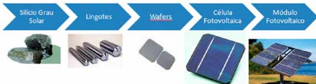
Fig. 5.17 Cadeia produtiva do módulo fotovoltaico baseado em silício cristalino. (Imagens: IPT, CEEG, Inovação Tecnológica.)
