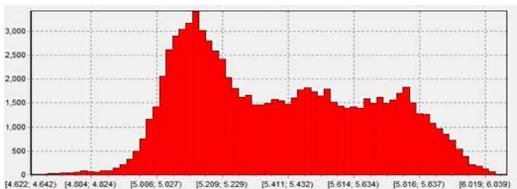
Fig. 5.4 – Histograma com irradiação em plano inclinado igual à latitude do local. Observa-se grande ocorrência de irradiação em nível superior a 4,8 kWh/m<sup>2</sup>/dia. Fonte: SWERA.
