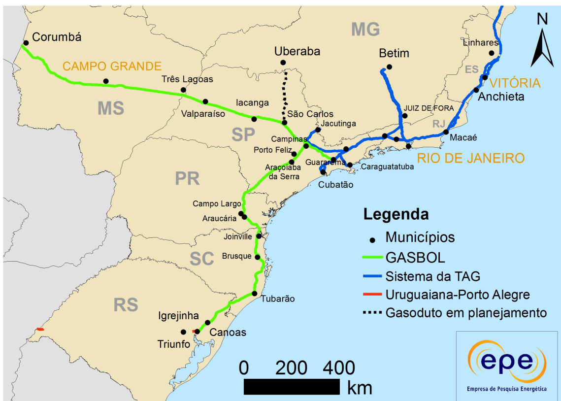
Figura 2.19– Sistema de gasodutos de transporte da Região Sul/Sudeste/Centro-Oeste
