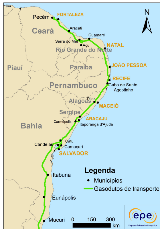
Figura 2.18 – Sistema de gasodutos de transporte da Região Nordeste
